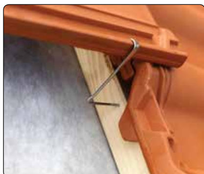
Sidofalsklammer att spikas i 45 x 70 och 25 x 50 läkt.
